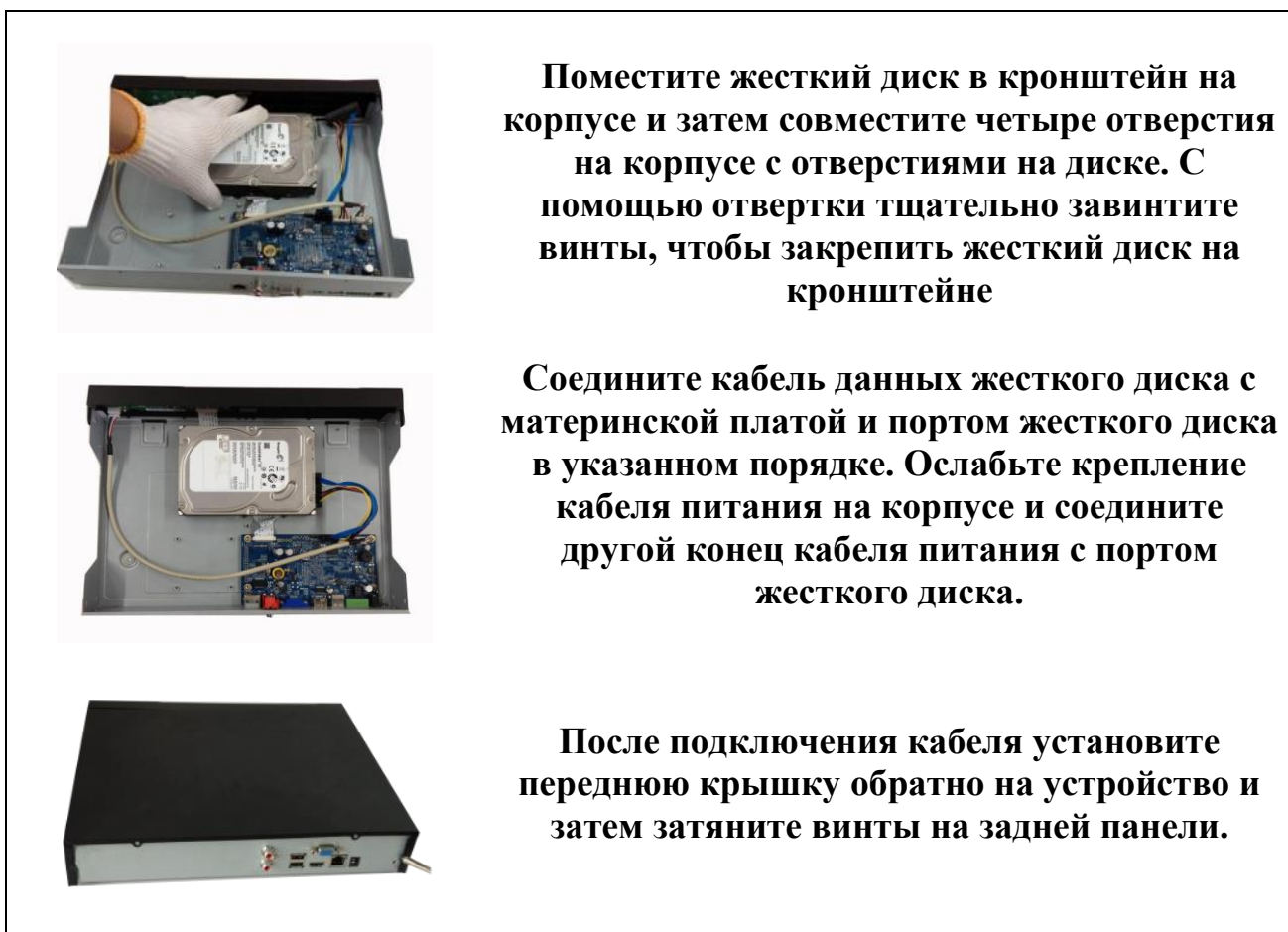
Рисунок 5.1 Установка жесткого диска
