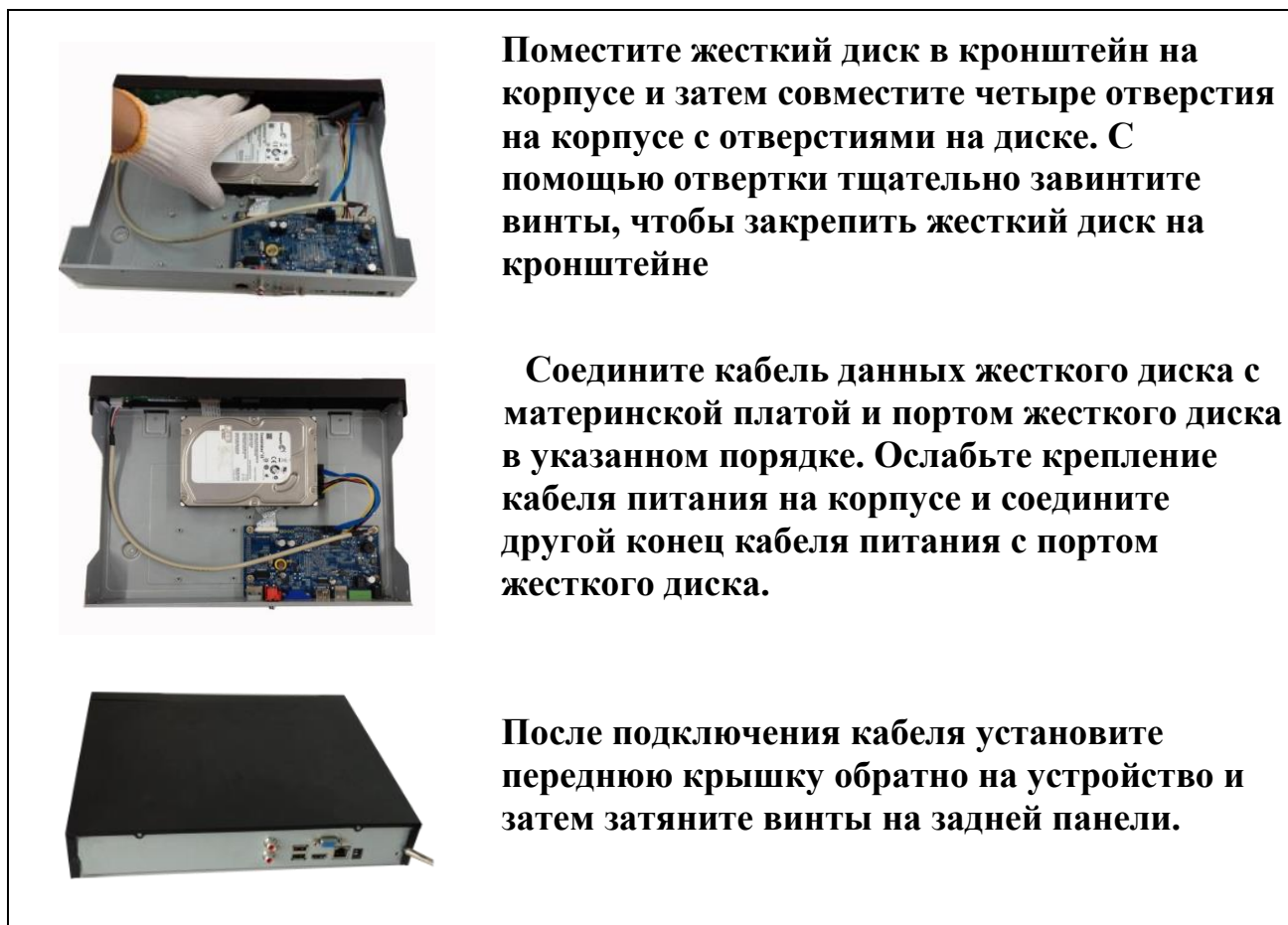
Рисунок 5.1 Установка жесткого диска
