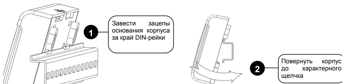
Рисунок 15. Монтаж устройства на DIN-рейку
