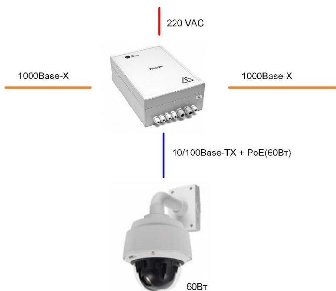
Рисунок 1.1 - Схема подключения одной камеры с потреблением 60 Вт.
